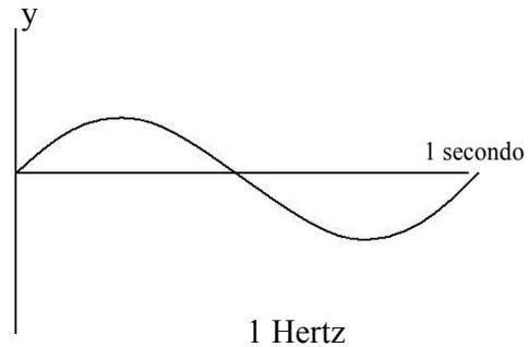
Supponendo che la lunghezza dell'asse orizzontale rappresenta un secondo, i grafici sopra mostrano onde sinusoidali con differenti **frequenze** misurate in Hertz. Un Hertz significa un'oscillazione completa al secondo. Più alta è la frequenza, più alta è la vibrazione, quindi quando si parla di evolvere e aumentare la nostra vibrazione, questa è la misura specifica a cui si rimanda.
